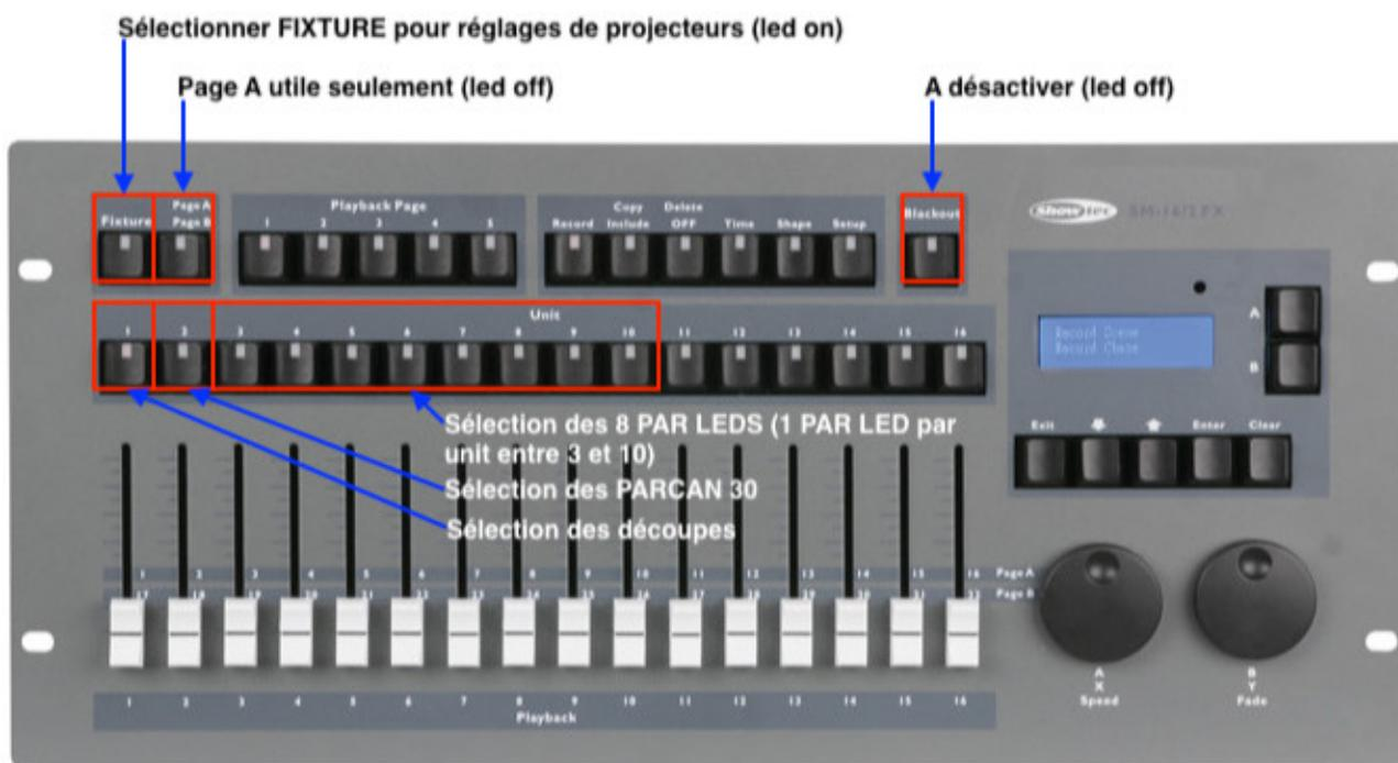
A l'allumage de la console, et après avoir vérifié le branchement des 2 câbles DMX sur les splitters du rack, vérifier que le bouton "**BLACK OUT**" soit désactivé (*led off*), et cliquer sur **FIXTURE** (*led on*). De manière générale, le bouton "**PAGE A/PAGE B**" doit rester sur **PAGE A** (*led off*).
